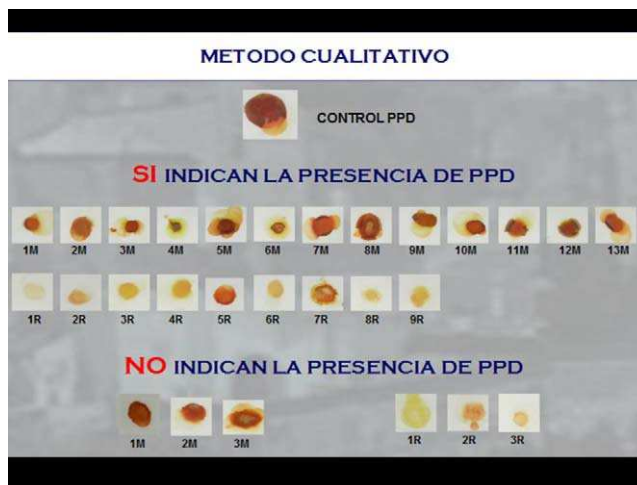
Figura 3 Resultados del método cualitativo de detección de PPD.
